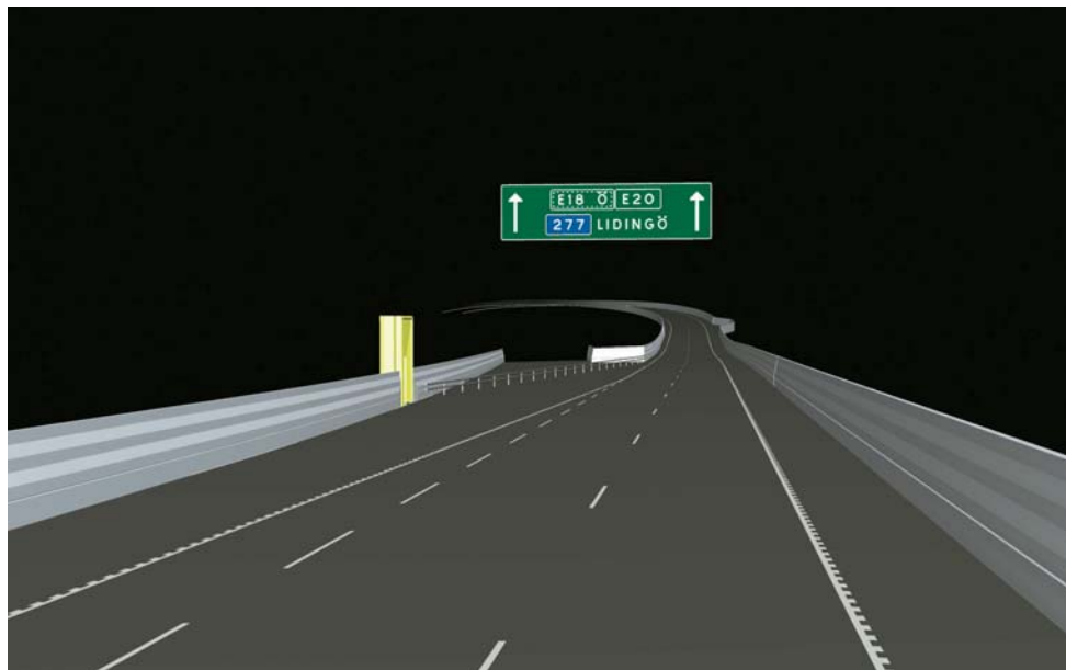
Visualisering gjord i MicroStation från 3D-materialet. En vägschild har placerats in i rätt läge. Bergytan är släckt i bilden.
