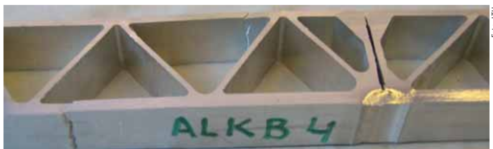
Fig.2: Tvärsnittet av däck i krigsbron Kb71.
